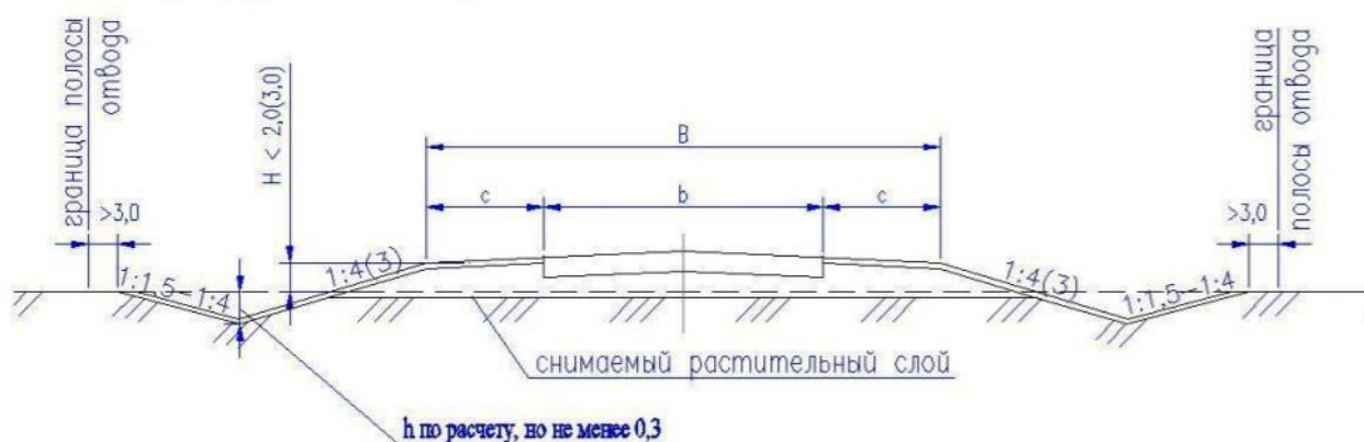
Рисунок 14 – Насыпь из привозных грунтов
